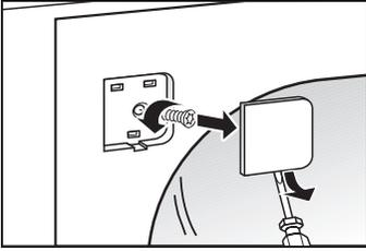
1. Enlevez les deux caches du système de fixation de la porte : A l'aide du tournevis à fente, dégagez les caches avec précaution.
