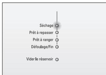
Le sèche-linge dispose d'un système de balayage électronique qui contrôle l'humidité du linge au cours des programmes standard et du programme Rapide. Le séchage s'arrête automatiquement dès que le degré de séchage programmé est atteint. Les voyants (DEL) indiquent l'état en cours du cycle de séchage.
